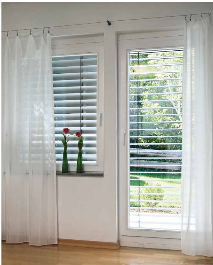
Flexible Anpassung des Tageslichtes: Außenraffstores von innen gesehen.
