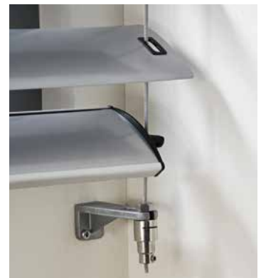
Lamellenbreite 80 mm, flexibel, mit Winkel und Federtopf zur automatischen Seilspannung
