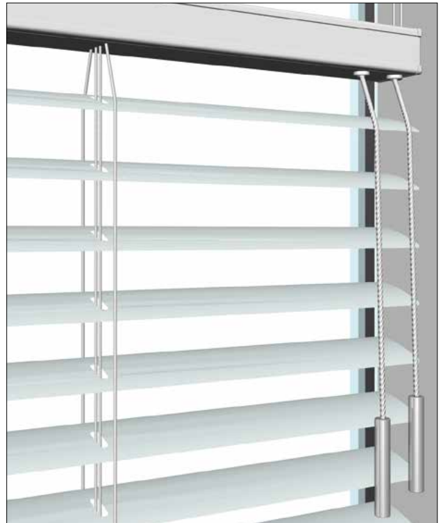
Die Lamellenwendung wird bei schwer erreichbaren Fenstern durch eine Wendeschnur möglich (Bedienlänge wird auf die benötigte Länge individuell gefertigt).
